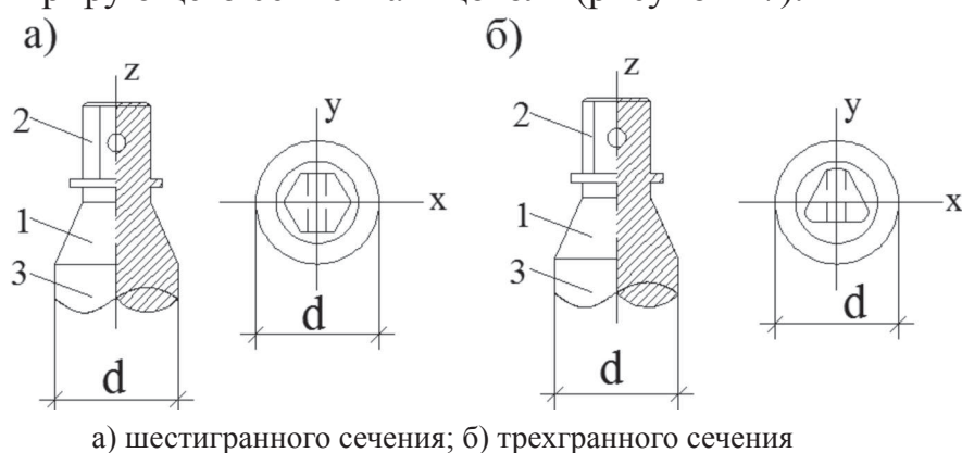
Рисунок 17 – Типовые конструктивные схемы хвостовиков РСу
